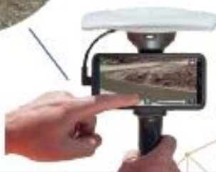
Rzeczywistość rozszerzona - Cyfrowy model na budowie
