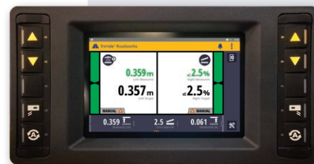
Ekran Trimble Roadworks 2D jest wyposażony w dotykową klawiaturę do użytku w terenie
